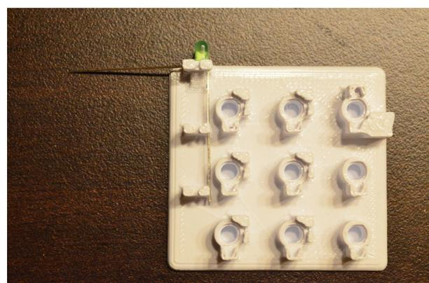
2.折り曲げたLEDを治具Aに左図のようにセットします。
